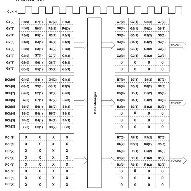
Figure 4-3. 16-Bit RGB 4:4:4 Data Format
