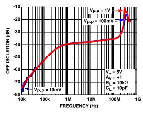
FIGURE 10. OFF ISOLATION vs FREQUENCY
