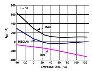
FIGURE 24.  $I_{10}$  vs TEMPERATURE  $V_S = \pm 2.5V$
