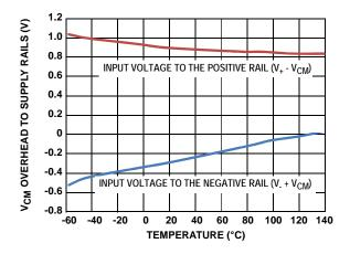
FIGURE 29. INPUT COMMON MODE VOLTAGE vs TEMPERATURE
