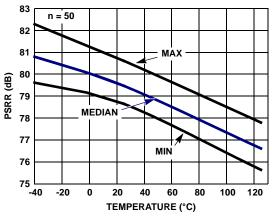
FIGURE 26. PSRR vs TEMPERATURE ±1.5V TO ±2.5V
