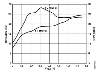
Figure 31. OIP3 vs.  $V_{\rm DBS}$
